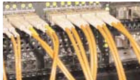
Kabelkunstwerk – Hochverfügbare Daten durch einen Fibre Channel Switch mit 10 Gigabit Verbindungen.
